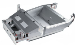
Verlijmd aluminium chassis van de Lotus Elise
